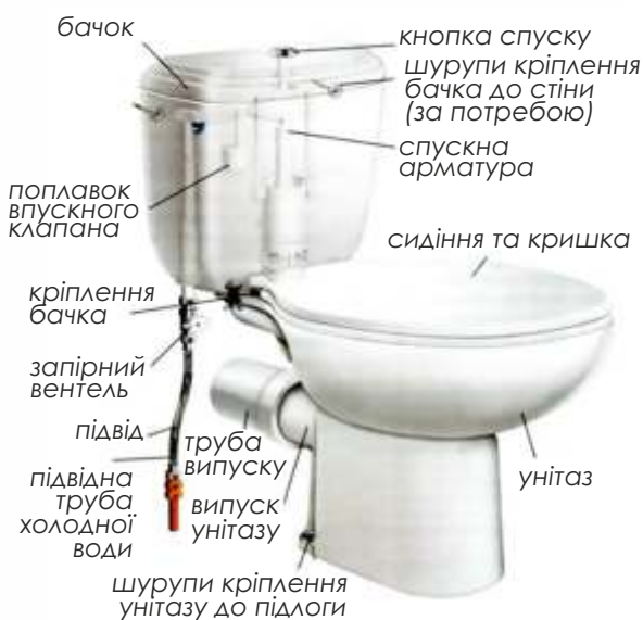
Рис. 42 - Конструкція унітазу
