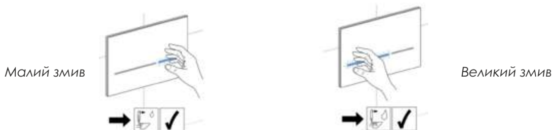
Рис. 49 - Функція подвійного змивання в безконтактній клавіші
